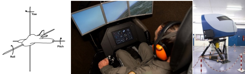
Figura 4 – Simulador Gyrogma e eixos de movimento do avião
